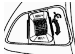
Управление скоростью круиз-контроля
